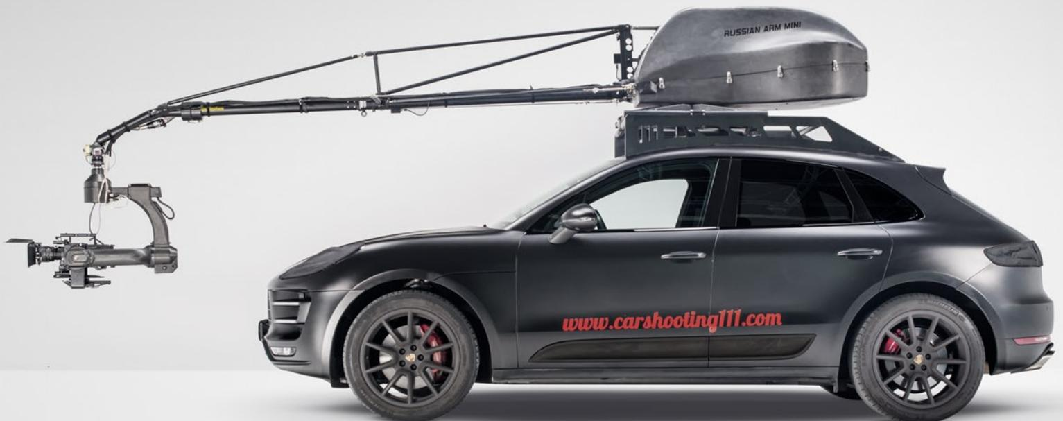
El Russian Arm Mini es ligero y compacto, pero lo suficientemente potente como para ir a alta velocidad y trabajar en las condiciones más difíciles. Es capaz de panear 360°, inclinación hacia arriba y hacia abajo que permite una amplia gama de tomas.
