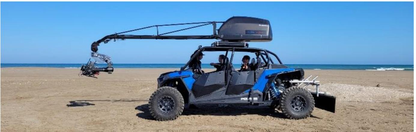
Vehículo todoterreno compacto de 4 plazas con una potencia y distancia del suelo que le permite rodar en playas, pasos estrechos, terrenos fangosos y rocosos.
