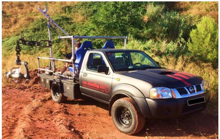
Este vehículo es sin duda ideal para rodajes donde se precisa un cámara car pequeño. Totalmente equipado para "gripar" cámara, con estructura tubular de 48 mm de aluminio, plataformas y adaptadores varios.
