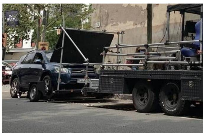
Diseñado para remolcar tanto turismos como motos o bicicletas a una distancia mínima del suelo permite cualquier rig en su tubería de 48mm.
